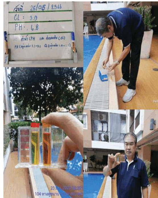
ภาคผนวกที่ 3.10 การตรวจสอบ วัดค่าความเป็นกรดต่าง (PH) และปริมาณคลอรีน
